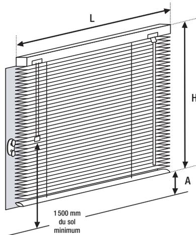
**L :** Largeur du store. Le boîtier peut être plus large que le châssis de la fenêtre. Prendre les mesures fenêtres ouvertes.
