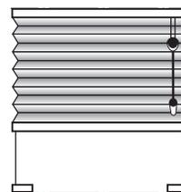
Guidage par 2 câbles nylon dans la barre de charge.
