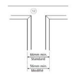
12 Lorsque deux fenêtres sont positionnées côte à côte, ou si le profil de recouvrement est particulièrement étroit, un boîtier raccourci est disponible.
