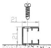
Perçage diamètre 8 mm à 75 mm du haut et du bas avec un écart maxi de 750 mm entre les trous, avec bouchons :
