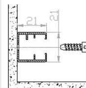
Perçage diamètre 8 mm à 75 mm du haut et du bas avec un écart maxi de 750 mm entre les trous.
