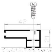
Perçage diamètre 8 mm à 75 mm du haut et du bas avec un écart maxi de 750 mm entre les trous, avec bouchons :
