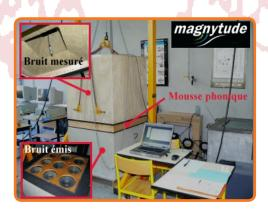
Mesure de la transmission du bruit à travers une tôle de 1 mm et d'une mousse acoustique (simulation d'un capotage machine)
