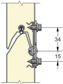
Logement du nœud de charnière vers l'intérieur du panneau évitant tout problème de positionnement de celle-ci. Le passage des taraudeurs au travers de trois épaisseurs de tôle assure la solidité de leur maintien.
