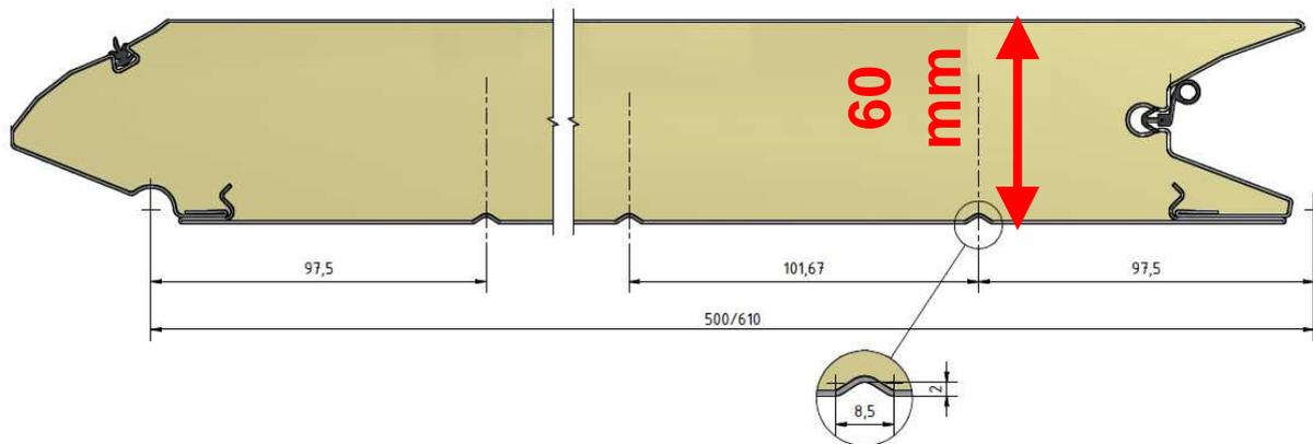
Les tôles ont une épaisseur de 0,48mm à l'extérieur et de 0,30 mm à l'intérieur.
