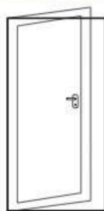
Poussant gauche (pose en applique ou en tunnel) vue extérieure
