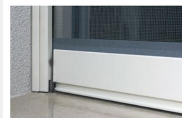
Grande élégance de la barre de manœuvre avec adaptateur mobile qui rend possible une adhérence horizontale parfaite et empêche les insectes de passer. Ce dispositif permet d'absorber d'éventuelles irrégularités dans l'ajustage du fin de course.
