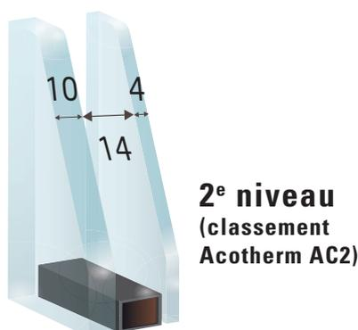
La fenêtre est équipée d'un vitrage phonique composé d'une glace de 10 mm, d'une lame d'air déshydraté de 14 mm et d'une seconde glace de 4 mm.
