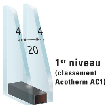
La fenêtre est équipée d'un double vitrage classique, composé d'une glace de 4 mm, d'une lame d'air déshydraté de 20 mm et d'une seconde glace de 4 mm.
