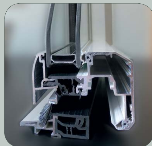
Seuil pour portes-fenêtres Option seuil réduit de 20 mm avec doubles joints d'étanchéité et rejet d'eau Alu.
